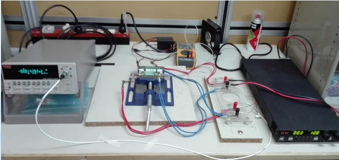
Figura 7: Montaje experimental para aplicar el método de Van der Pauw.
