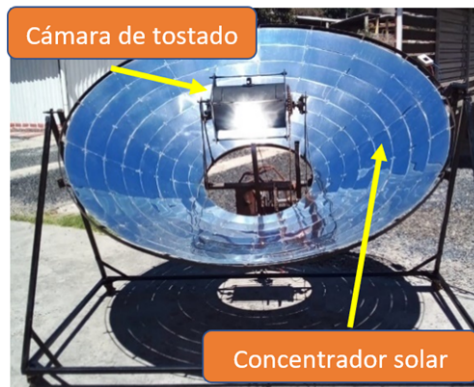
Figura 1: Concentrador solar de Fresnel anidólico y la tostadora de café Fuente: Elaboracion Propia
