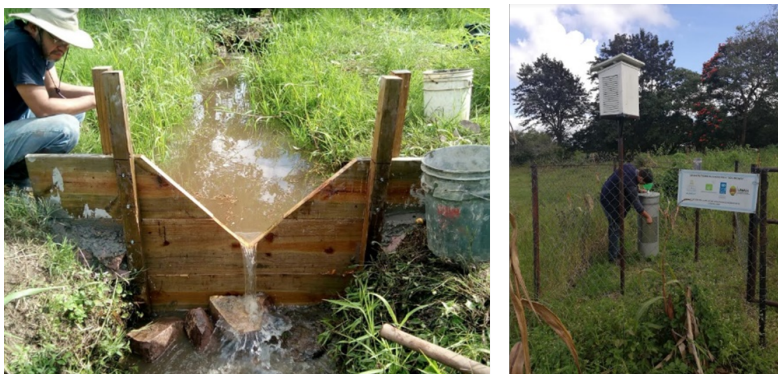
Figura 7: Estaciones de monitoreo de caudal, termoplumiométrica e isotópica. Fuente: Fotos propias para el estudio
